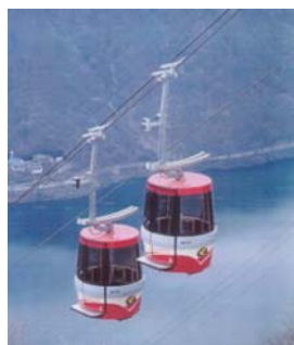
図4 屋根に動吸振器をつけたゴンドラ
