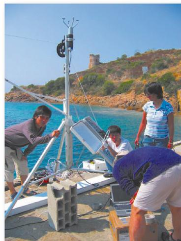
図5：屋外での風速測定の様子
