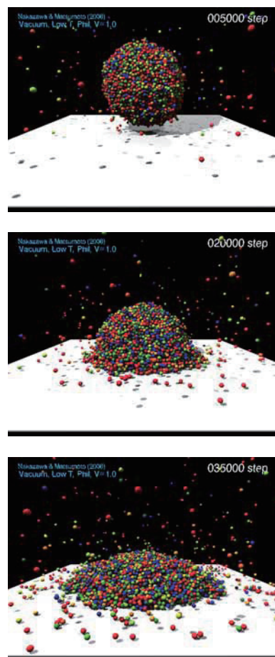
図4 親水性固体壁面への液滴衝突の分子動力学シミュレーションの例
